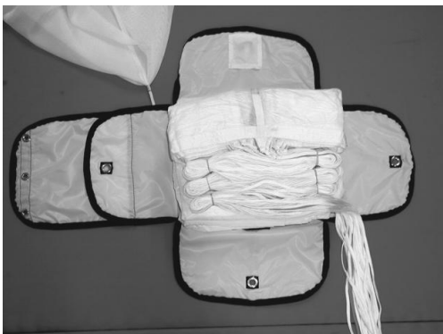
21. Kappe um 180° drehen und in Innenkontainer legen.
