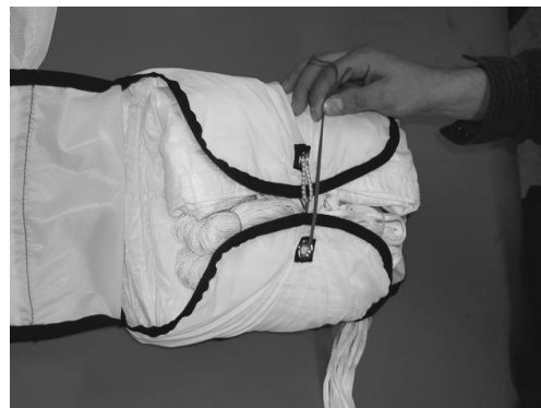
22. Gummi durch die Öse ziehen...
