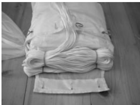
22. Leinenbündel an der Basis platzieren und die Fangleinen durch den Containerschlitz führen wie abgebildet
