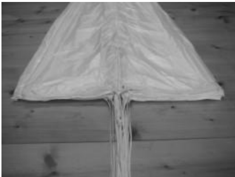
5. Bahnen links und rechts falten, je 12 Bahnen, Bahn #1 oben auf
